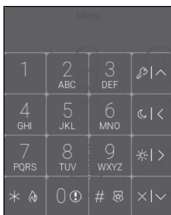
Rys. 9. Terminal w systemie VERSA.
