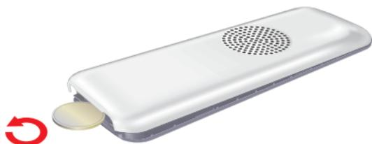
2. Placez la batterie dans son logement. Les broches conductrices de la batterie doivent être en contact avec les broches du boîtier.
